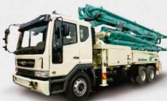
Bombas de Concreto
